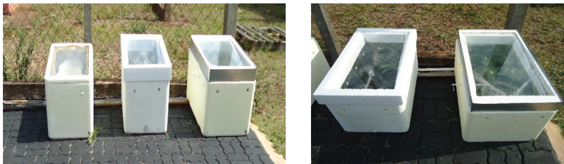
Figura 35 - Equipamentos construídos para redução dos resíduos aquosos contendo metais pesados, através da evaporação passiva
