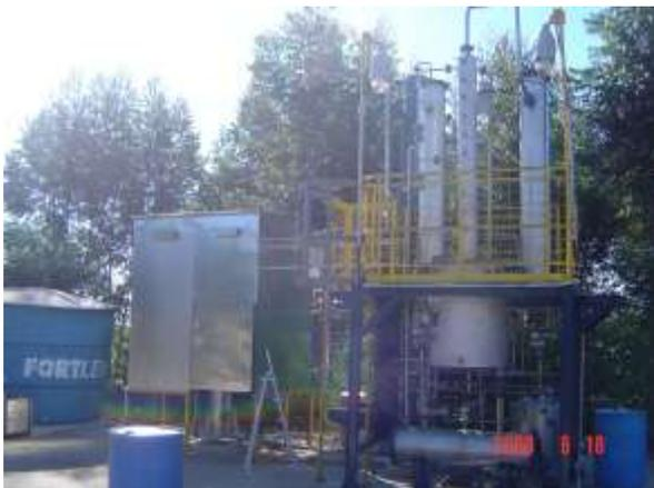
Figura 1: Planta – piloto, desenvolvida para recuperação de solventes orgânicos da FUFSCAR.
