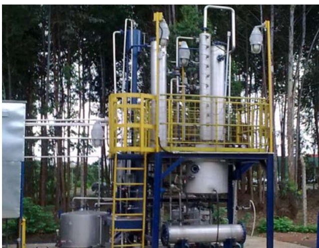
Figura 81 - Planta piloto para recuperação de solventes orgânicos gerados em laboratórios da UFSCar.
